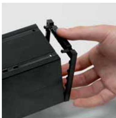
Fissare il circuito stampato montando la cornice posteriore Fix the printed circuit board by setting the rear frame
